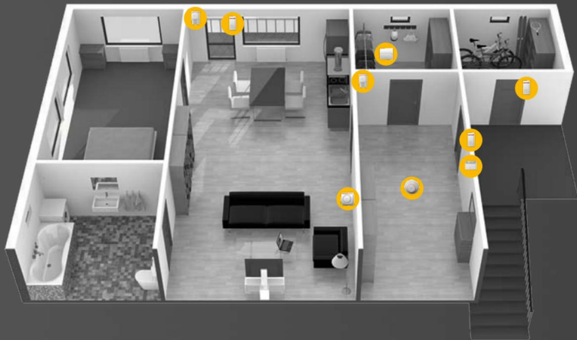
**Die Typinstallation für eine Musterwohnung wurde in der Funkversion vorbereitet, welche einen schonenden Umbau garantiert, die Montagezeit wesentlich verkürzt und damit auch den Preis für die Montage im Vergleich zu einem verdrahteten System reduziert.**
